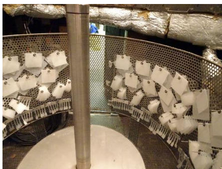
Figure 56. Arrangement des échantillons dans la chambre d'irradiation [2].
