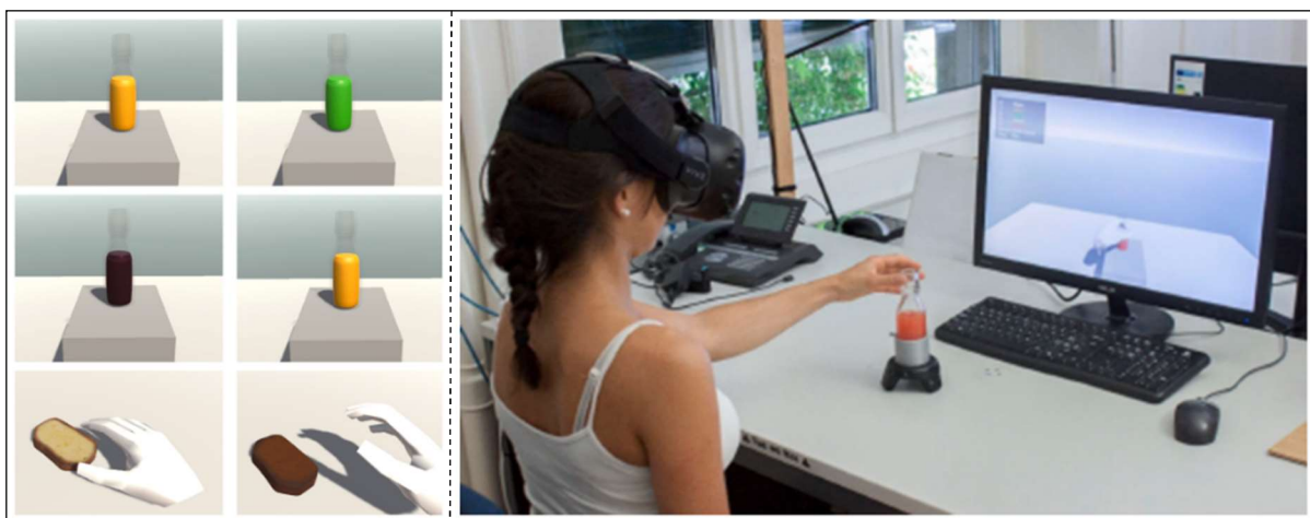
Figure 13. Exemple de modulations visuelles du produit en réalité virtuelle. Gauche : Vues VR ; Droite : Saisie réelle (Ammann, Stucki, et al., 2020).
