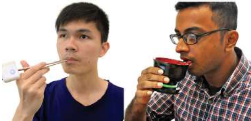
Figure 49. Ustensiles développés à l'illusion de saveurs, par stimulations électriques (Ranasinghe et al., 2019).
