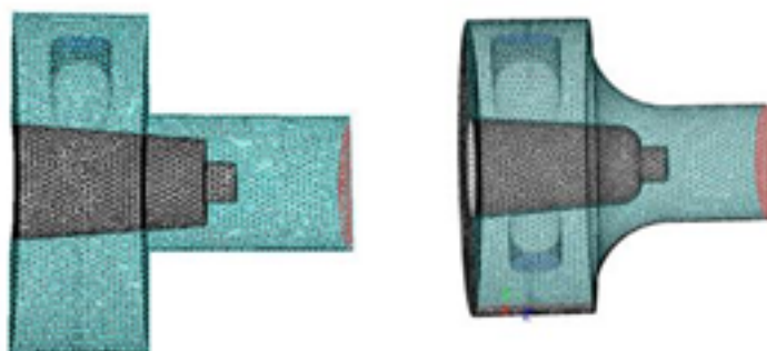
FIGURE 5.2: Maillages de la géométrie actuelle du réacteur (à gauche) et de la géométrie optimisée (à droite). Modèle 3D non-réactif.
