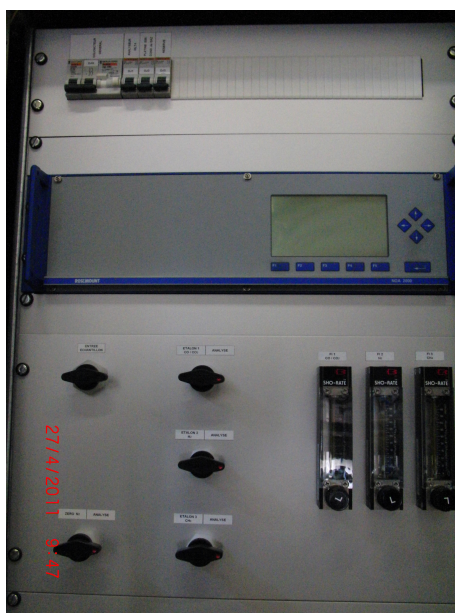
FIGURE 2.15: Photographie de la baie d'analyse en continu NDIR-TCD.
