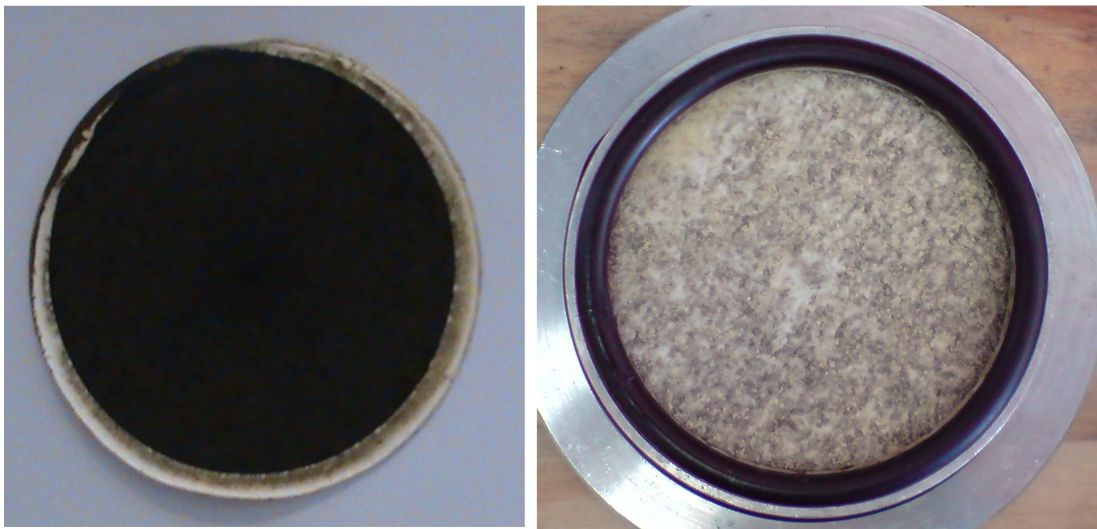
FIGURE 3.11: Filtre présent avant la baie d'analyse montrant les suies lors du reformage de gazole dans les cas PO_x (à gauche) et ATR (à droite).
