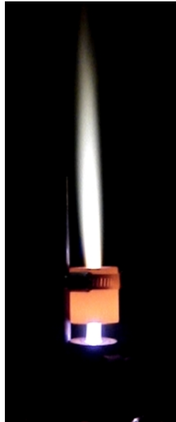
FIGURE 4.31: Photographie d'une torche plasma à tuyère sectionnée fonctionnant à l'azote.
