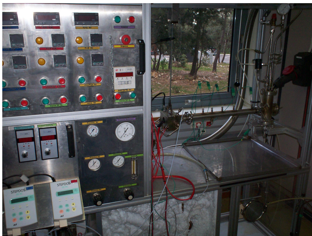
FIGURE 2.2: Photographie du banc expérimental modifié pour l'application de purge d'un \text{NO}_x trap.
