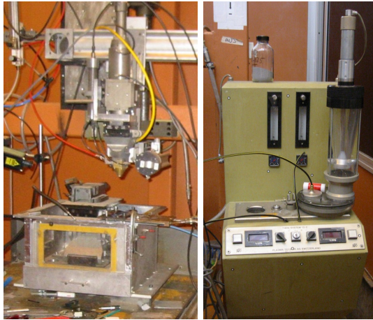
Figure I.1 – Machine de projection laser Limoges et son distributeur de poudre
