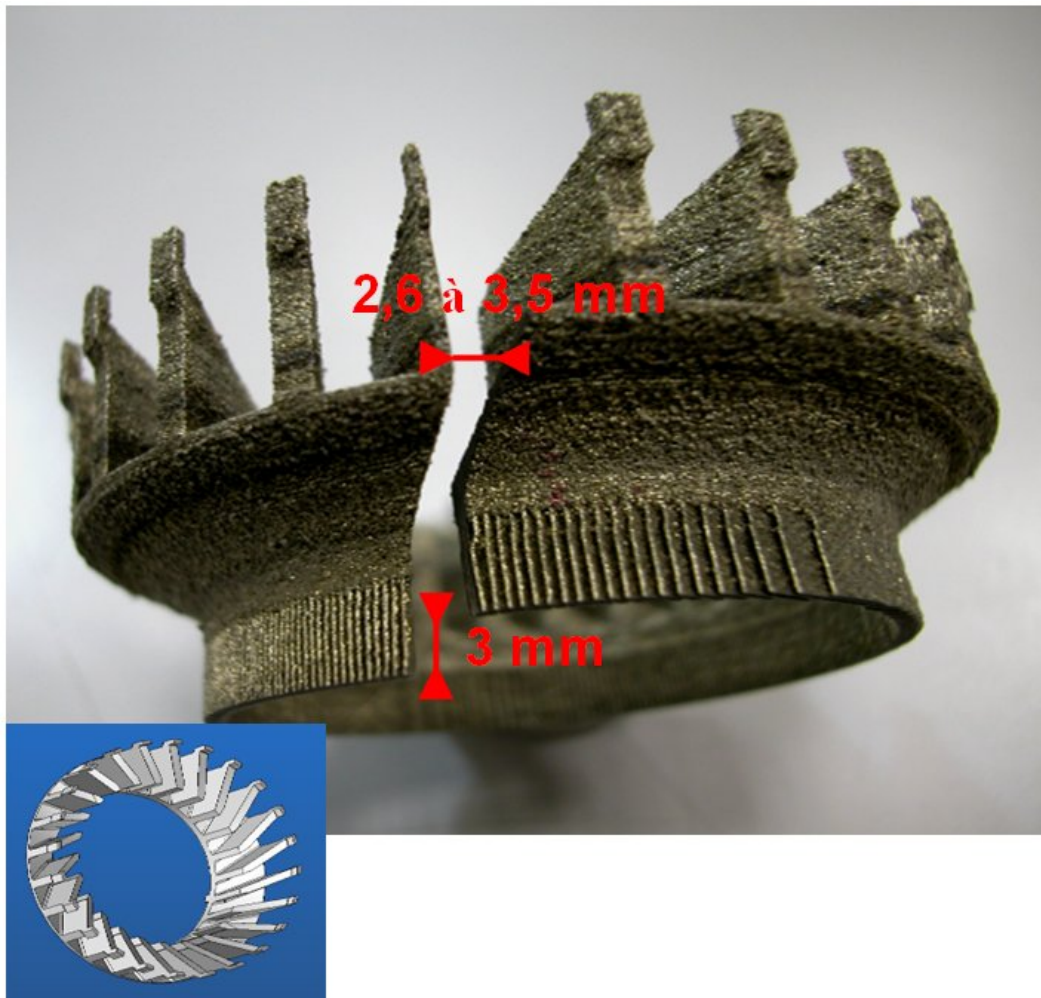
Figure II.12 – Mise en évidence des contraintes résiduelles dans la vrille d'injection en IN718 de Snecma après une découpe au fil par électroérosion
