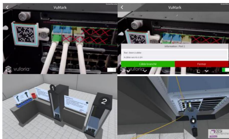
Figure 27 : Application d'assistance à l'opérateur en réalité augmentée (en haut) et formation en réalité virtuelle (en bas) basées sur le modèle extrait de (Richard et al., 2018)
