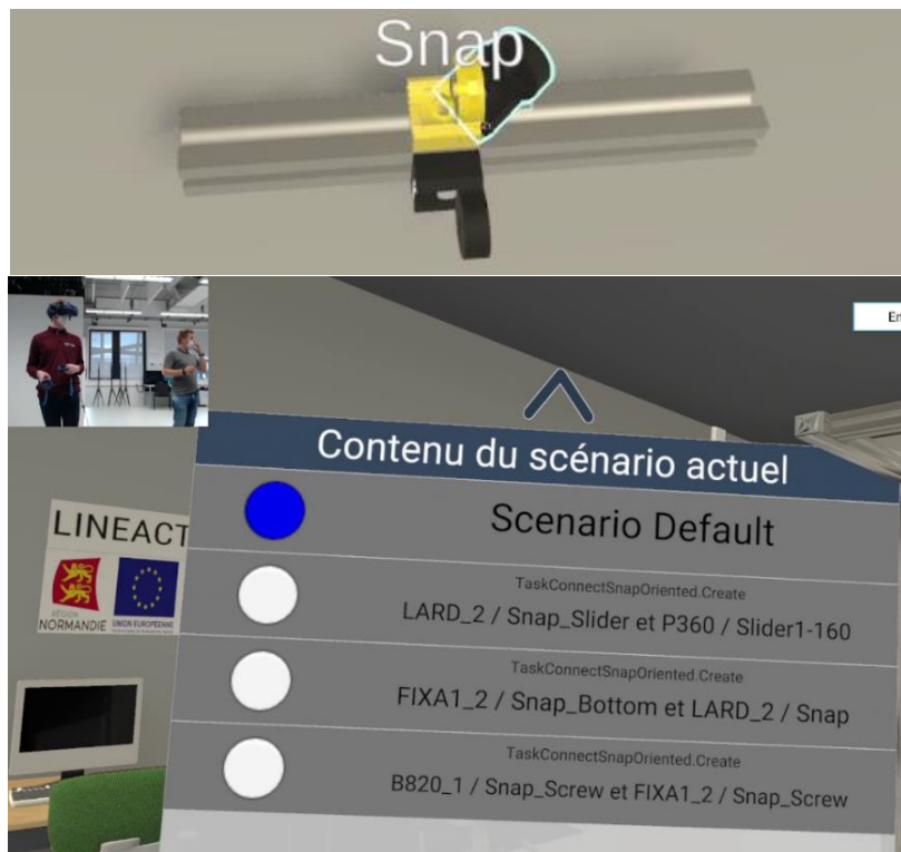
Figure 101 : (en haut) L'assemblage en cours de réalisation ; (en bas) Fenêtre montrant le scénario en cours d'édition par « authoring-by-doing ».
