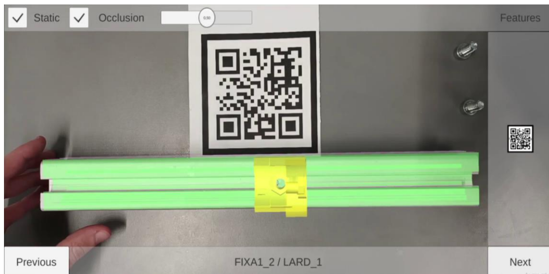
Figure 88 : Preuve de concept du guidage à l'assemblage en réalité augmentée.
