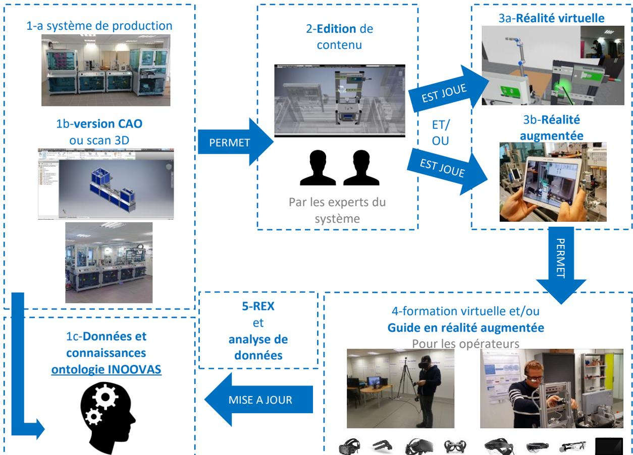
Figure 41 : Processus de création de contenu et d'usage en RA/RV via l'ontologie INOOVAS, extrait de (Havard et al., 2017)
