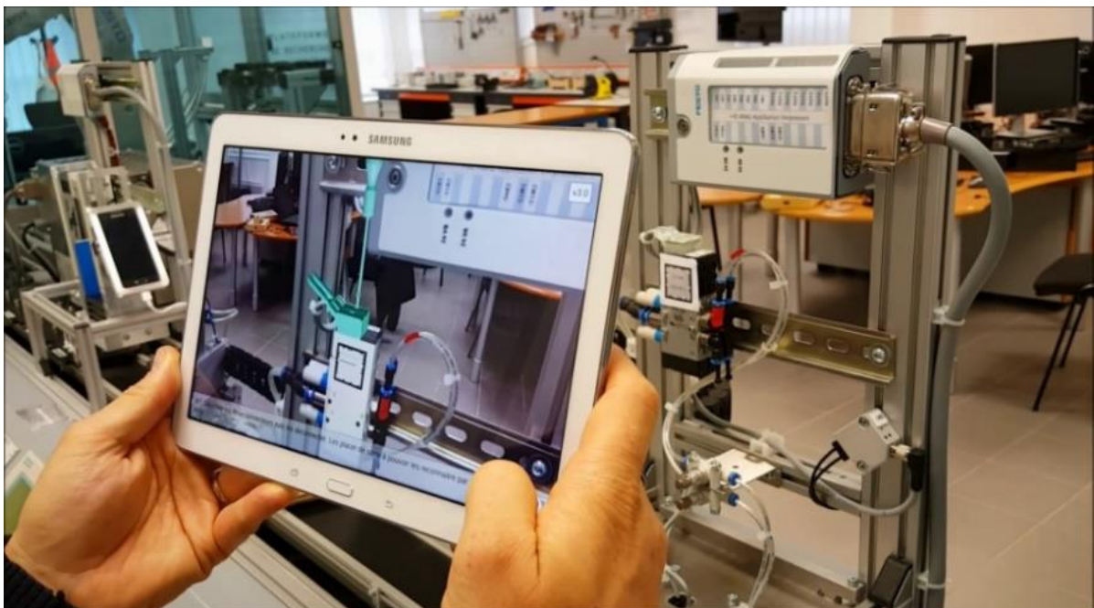
Figure 12 : Gamme de maintenance industrielle en réalité augmentée sur une chaîne de production (Havard et al., 2016, 2017; Richard et al., 2016)
