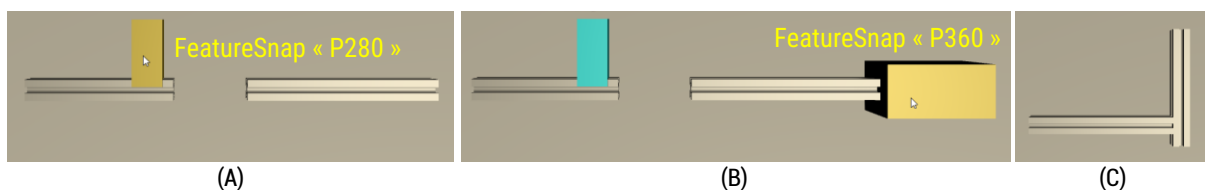
Figure 62 : Création d'une relation depuis une preuve de concept du framework INTERVALES. (A) Sélection de la première feature à connecter sur l'Entity « P280 » (en jaune) ; (B) Sélection de la seconde figure à connecter sur l'entity « P360 » (en jaune), la première feature sélectionnée apparaît en bleu ; (C) Résultat de la relation mise en place.
