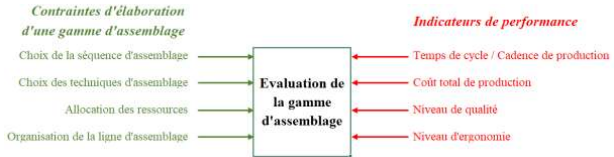
Figure 15 : Elaboration d'une gamme d'assemblage : Contraintes et Indicateurs de performance (Adaptée des travaux d'Andolfatto [78])
