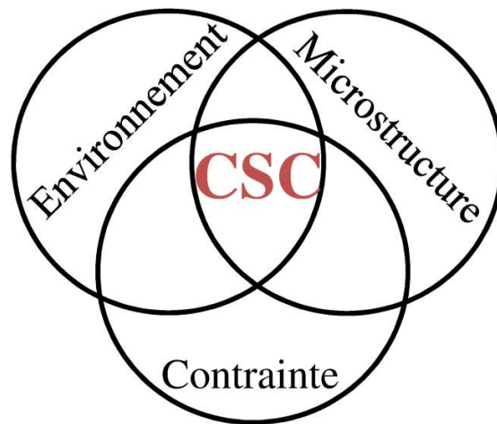
Figure 0-3: Diagramme représentant l'espace de sensibilité à la CSC et illustrant les trois facteurs de la corrosion sous contrainte [7].
