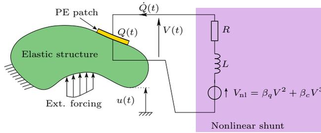
Figure 7.13: Circuit shunt non linéaire avec composante de tension quadratique et cubique.
