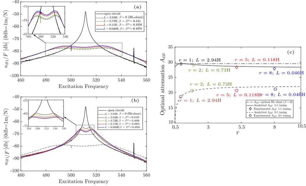
Figure 7.26: (a) et (b) montrent la réponse en fréquence expérimentale de la première harmonique de la vitesse  $u_{H1}$  pour différentes valeurs de l'inductance pour l'accord 1:1 et 2:1, respectivement. (c) Comparaison entre l'atténuation analytique optimale et celle mesurée expérimentalement pour les deux cas de réglage.
