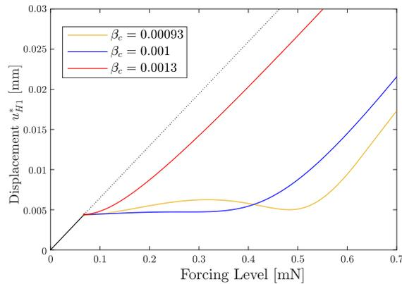
Figure 7.15: Amplitude de la première harmonique du déplacement de la pointe du foil évaluée à la fréquence de résonance, notée  $u_{H1}^*$ , en fonction de  $F$  pour trois valeurs différentes de  $\beta_c$ . Les tracés sont estimés pour  $\beta_q = 0.03$ ,  $\xi_e = 0.002$ ,  $r_1 = \omega_e/\hat{\omega}_1 = 0.5055$ . La réponse linéaire ( $\beta_q = \beta_c = 0$ ) est indiquée en noir, avec les réponses stables et instables représentées respectivement par des lignes pleines et pointillées.
