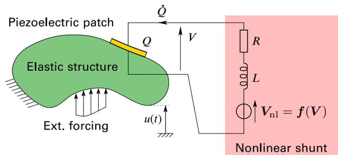
Figure 7.4: Schéma d'un circuit shunt non-linéaire avec une composante de source de tension non-linéaire  $V_{nl}$ .
