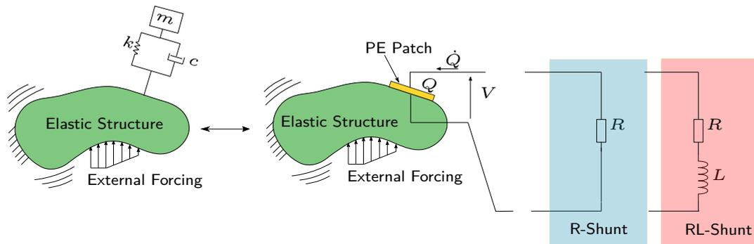
Figure 7.3: Schémas R-shunt et RL-shunt. Le patch PE désigne un patch piézoélectrique.  $Q$ ,  $\dot{Q}$  et  $V$  sont la charge dans l'électrode piézoélectrique, la dérivée temporelle de la charge (c'est-à-dire le courant) et la tension aux bornes du patch piézoélectrique.
