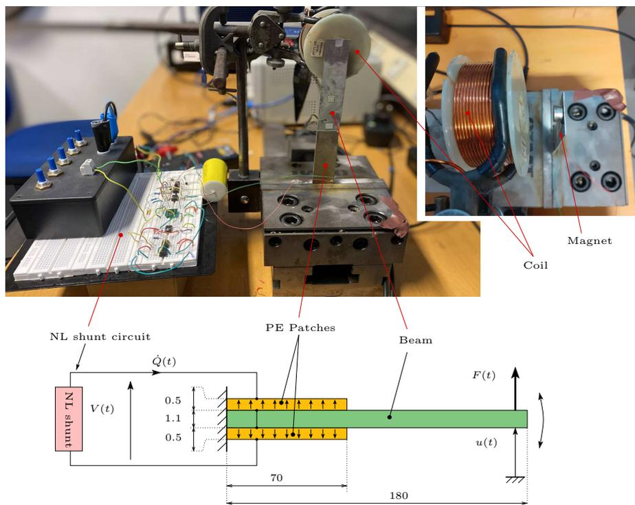
Figure 7.9: Montage expérimental. Les dimensions sont en mm. La largeur de la poutre et des patches PE est 30,5 mm.
