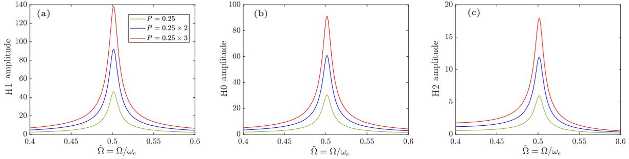
Figure 7.21: Harmoniques H1 (a), H0 (b) et H2 (c) des solutions périodiques de l'Eq. (7.19) au voisinage de la résonance primaire, en fonction de  $\tilde{\Omega} = \Omega/\omega_e$  pour  $\xi_e = 0.005$  et différents niveaux d'excitation  $P$ . Les valeurs numériques utilisées dans les simulations sont  $\xi_e = 0.005$  et  $\beta = 0.444$ .
