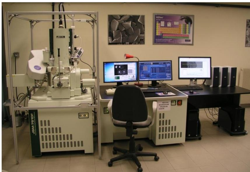
**Figure II.4 :** Photographie du MEB (SEM-JEOL JSM 7610 F).
