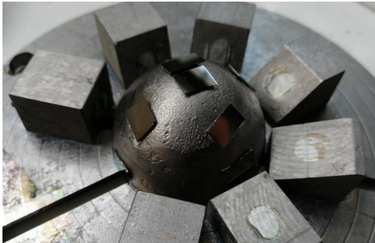
**Figure IV.27.** Image de la tête fémorale positionnée sur le porte-substrat.
