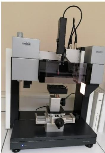
**Figure II.9 :** Appareil de mesure d'angle de contact Krüss DSA100.
