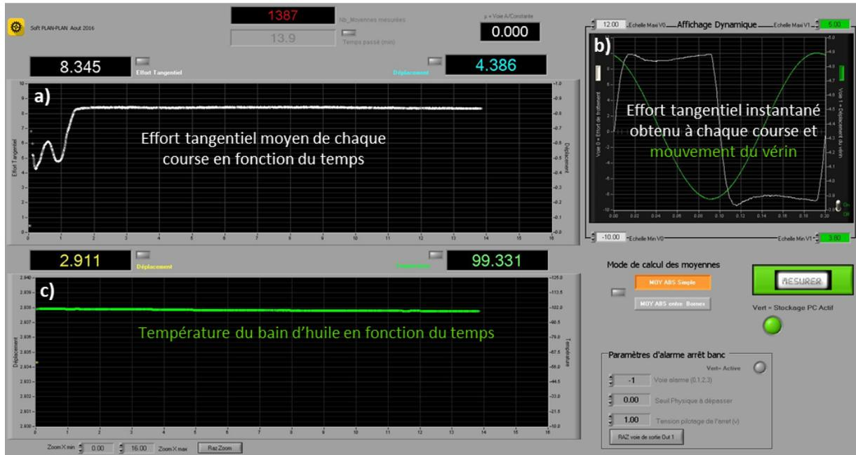
Figure 2-21 : Logiciel interne Renault permettant la visualisation de a) l'effort tangentiel instantané et b) moyenné sur chaque course et de c) la température du bain d'huile.
