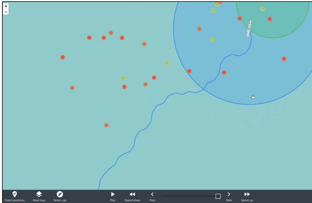
Figure 4-14 : Représentation de l'IHM - visualisation des préconisations de l'agent jusqu'à la zone d'arrivée
