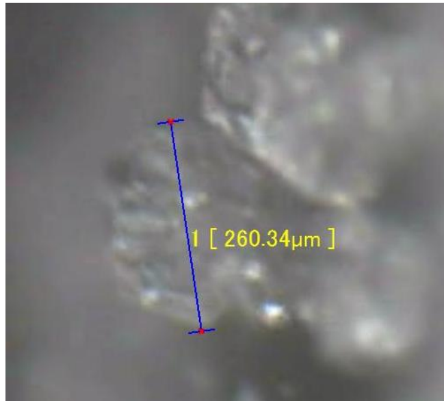
Figure 3.11 : Cristal sphérique de CO 2 solide (200x de grossissement)
