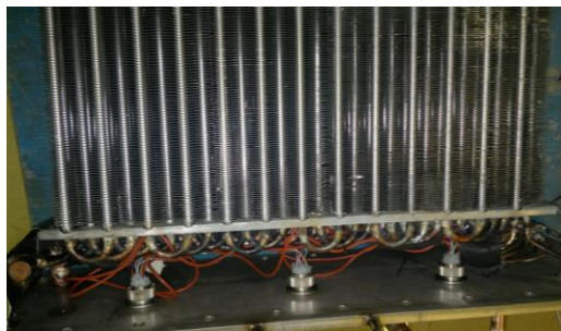
Figure 3.1 : Echangeur tubes-aillettes de givrage de CO_2 (CFX)
