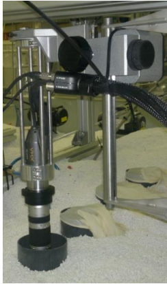
Figure 3.3 : Moteur pas à pas, caméra et objectif
