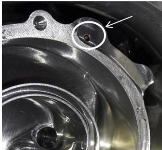
**Figure 109 : Sortie du conduit de retour d'huile**
