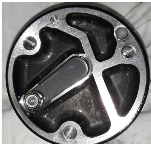
**Figure 105 : Vue du clapet anti-retour**
