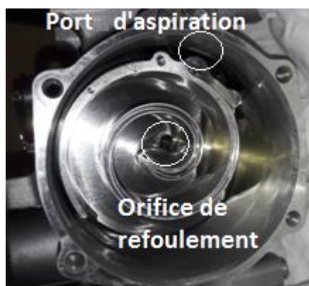
Figure 107 : Vue de la spirale fixe avec l'orifice de refoulement B et le port d'aspiration
