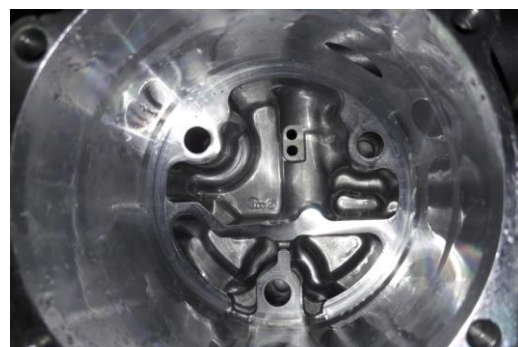
Figure 108 : Vue du séparateur d'huile et des deux orifices de connexion avec l'environnement de décharge
