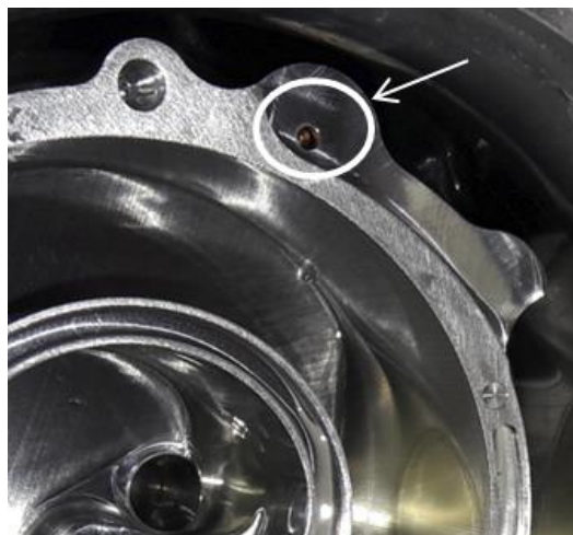
Figure 109 : Sortie du conduit de retour d'huile
