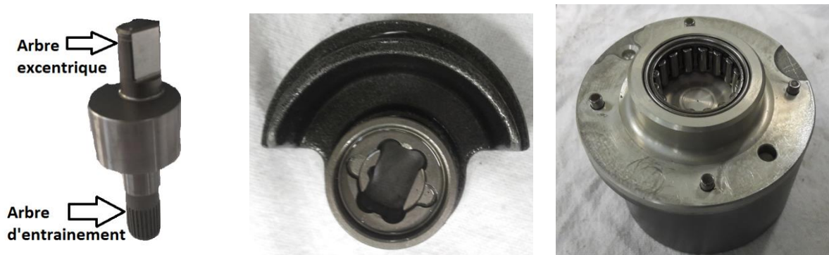
Figure 112 : Exemples (a) Arbre compresseur (b) bague de guidage avec contrepoids (c) palier à aiguilles en bas de la scroll mobile
