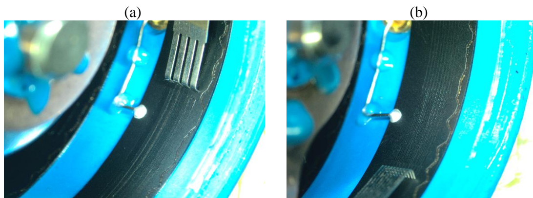
Fig. VII.3 : Photographies des différents contacts de la piste polymère avec les curseurs en alliage AgPdCu ; (a) Curseur classique 4 brins ; (b) Curseur 10 fils.
