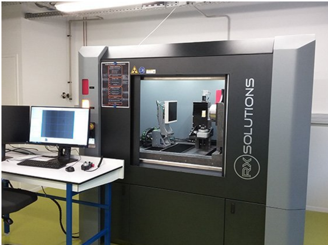
FIGURE 79 – Photographie du tomographe de l'institut Charles Sadron.
