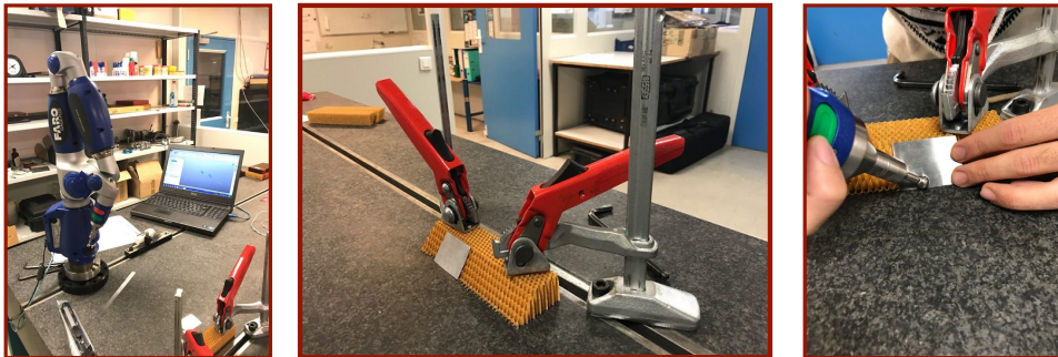
FIGURE A.12: Montage de la pièce à usiner pour la mesure de l'angle de chanfreinage dans la zone en régime permanent
