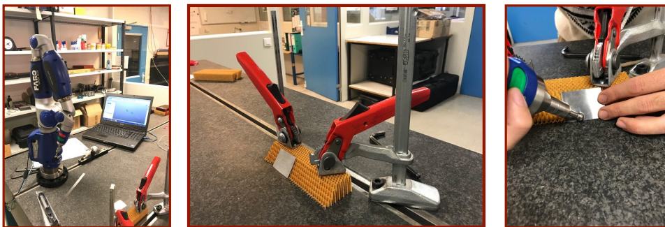
FIGURE A.12: Montage de la pièce à usiner pour la mesure de l'angle de chanfreinage dans la zone en régime permanent
