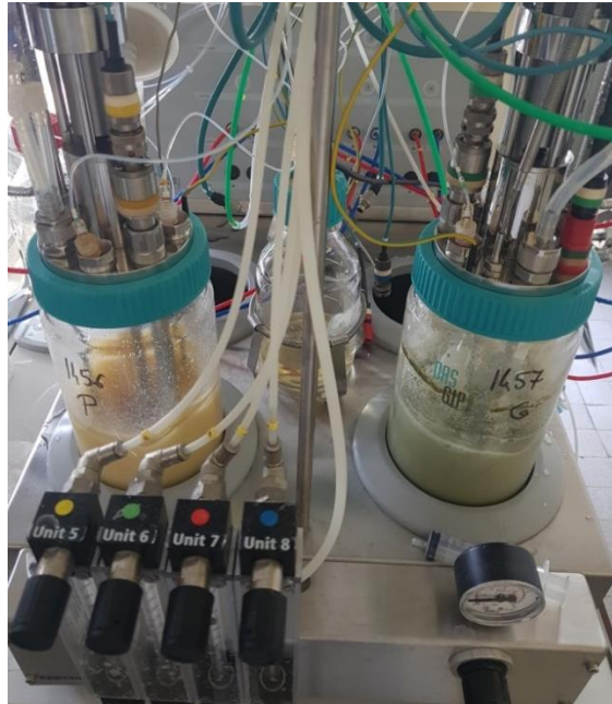
Figure IV.7. Photos des cultures des variants TR3060 P (à gauche) et TR3060 G (à droite) en fed-batch alimenté avec du lactose pur. On peut noter que le variant TR3060 G acquiert une couleur verte alors que le variant TR3060 P garde une couleur orangée.
