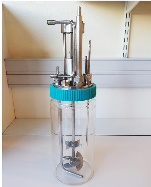
Figure IV.3. Photo d'un bioréacteur agité Dasgip de 1,5 L (Eppendorf, Hambourg, Allemagne), équipé de deux mobiles d'agitation (de type Rushton et oreille d'éléphant)
