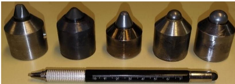
FIGURE 1.25. Inserts testés, de gauche à droite : Chisel, Cône4, Cône, S16 et S16.
