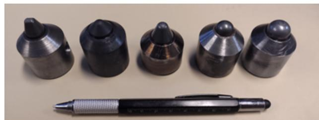
FIGURE 11. Plusieurs types d'inserts (de gauche à droite : chisel, deux différents inserts coniques et deux différents inserts hémisphériques).
