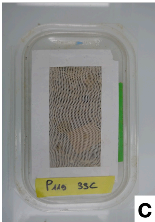
Figure 15 : Photos d'une enceinte climatique et de boîtes expérimentales utilisées lors de mes travaux. A : Enceinte climatique Panasonic MLR-352H. B : Disposition des boîtes d'élevage à l'intérieur des enceintes climatiques. C : Boîte d'élevage avec un filet sur la partie supérieure pour éviter la condensation d'eau. D : Intérieur d'une boîte d'élevage où les larves sont disposés sur de la vermiculite, avec un bloc de nourriture.
