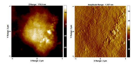
Figure2. Images AFM de la surface d'une microcapsule de gomme gellan. À gauche, l'image de topographie et à droite l'image en mode erreur (image dérivée de l'image topographique) provenant de la même zone. Champ de vision de 2 × 2 μm<sup>2</sup>.
