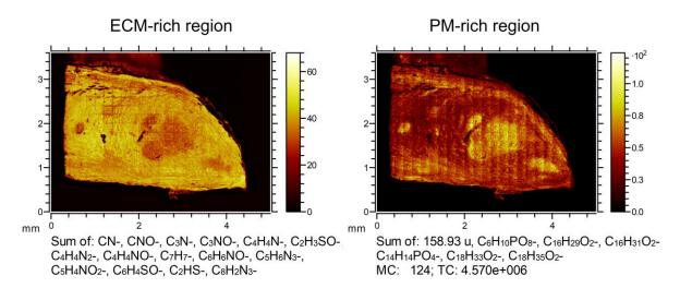
Figure 7. Images ToF-SIMS en mode négatif de la coupe SA18. À gauche, intensités totales des fragments caractéristiques des acides aminés, et à droite, intensités totales des fragments caractéristiques des phospholipides et des acides gras. Les images sont constituées de 468 (26 × 18) tuiles de 100 × 100 μm<sup>2</sup>.
