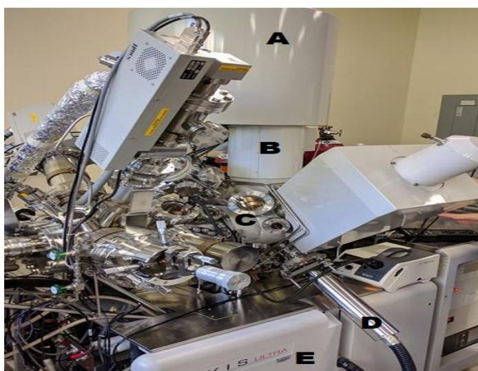
**Fig. 256** Equipement utilisé pour la spectroscopie de photoélectrons induits par rayons X (XPS)
