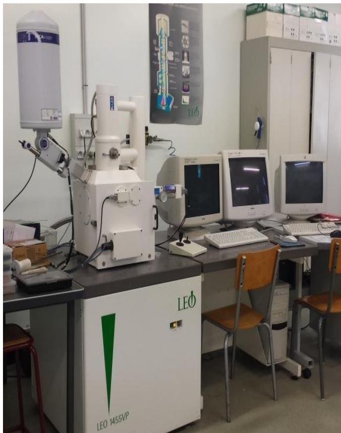
**Fig. 251** Photographie d'un appareil MEB équipé d'un détecteur EDS.
