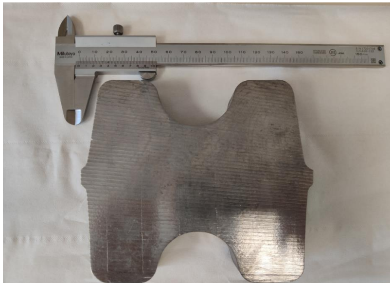
figure 3-6 : Tranche de pièce matricée de type "brake rod" utilisée dans l'intégralité de cette étude
