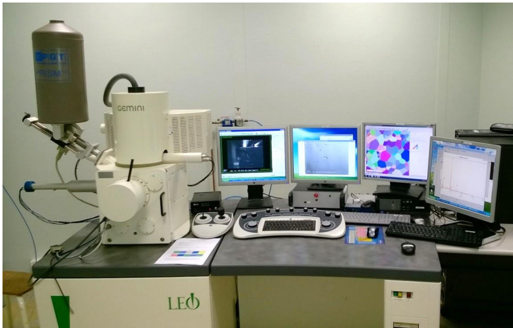
figure D-1 : Microscope électronique à balayage Zeiss
