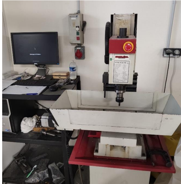
figure C-2 : Poste d'usinage des éprouvettes "bone shape"
