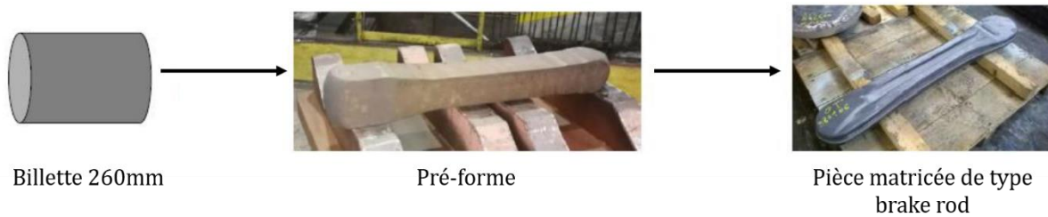
figure 3-5 : Etapes d'élaboration d'une pièce matricée de type "brake rod"
