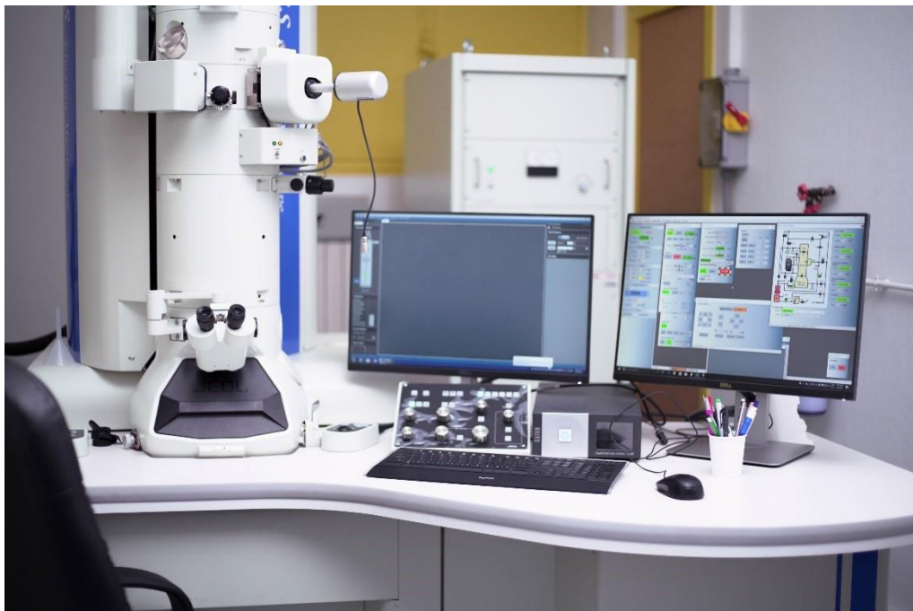
figure D-4 : Microscope électronique en transmission JEOL 2100Plus
