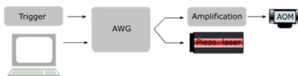
FIGURE IV.3 – Principe de contrôle du modulateur acousto-optique pour la création d'impulsions de lumière caractérisées en durée, puissance, et longueur d'onde.
