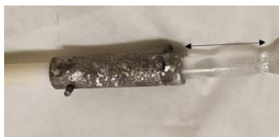
FIGURE II.9 – Photographie d'un germe de YSO dopé à l'ytterbium (flèche noire) à la fin d'une croissance, monté sur un porte germe en Ir partiellement oxydé.
