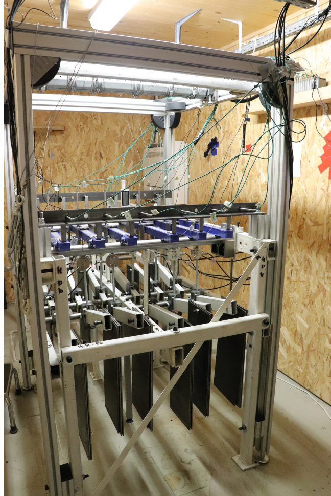
FIGURE 3.14 – Photo du bâti de fluage lors de la mise en charge des échantillons ayant l'âme dans le sens longitudinal
