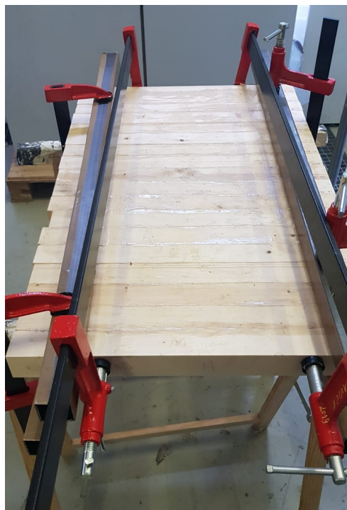
FIGURE 3.2 – Fabrication de la plaque dans laquelle sont découpées les éprouvettes ayant l'âme dans le sens radial
