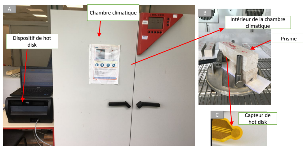
Figure 54. Dispositif de mesure thermique, (A) : chambre climatique et hot disk; (B) : vue intérieure de la chambre climatique ; (C) : capteur de mesure.
