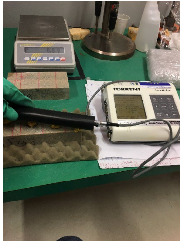
Figure 57. Mesures non-destructives : Méthode ‘The Wenner resistivimeter’.
