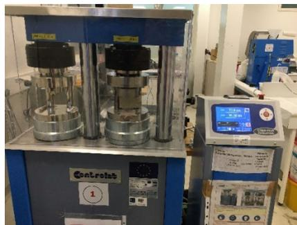
**Figure 52.** Essais de résistance en compression des mortiers.
