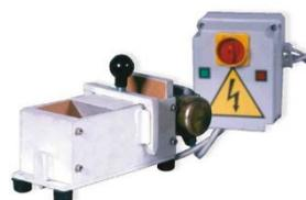
**Figure 49.** Maniabilimètre à mortier.
