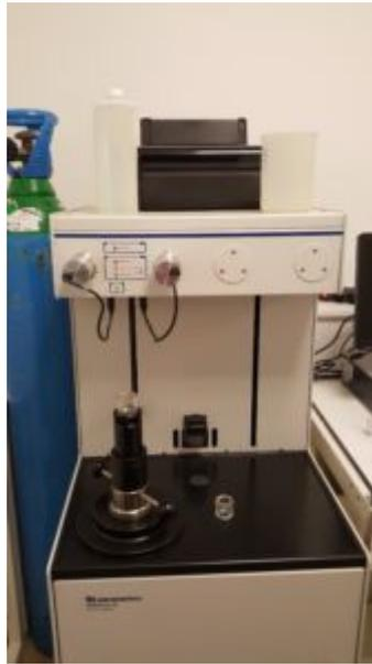
**Figure 55.** Essai de porosimétrie par intrusion au mercure.
