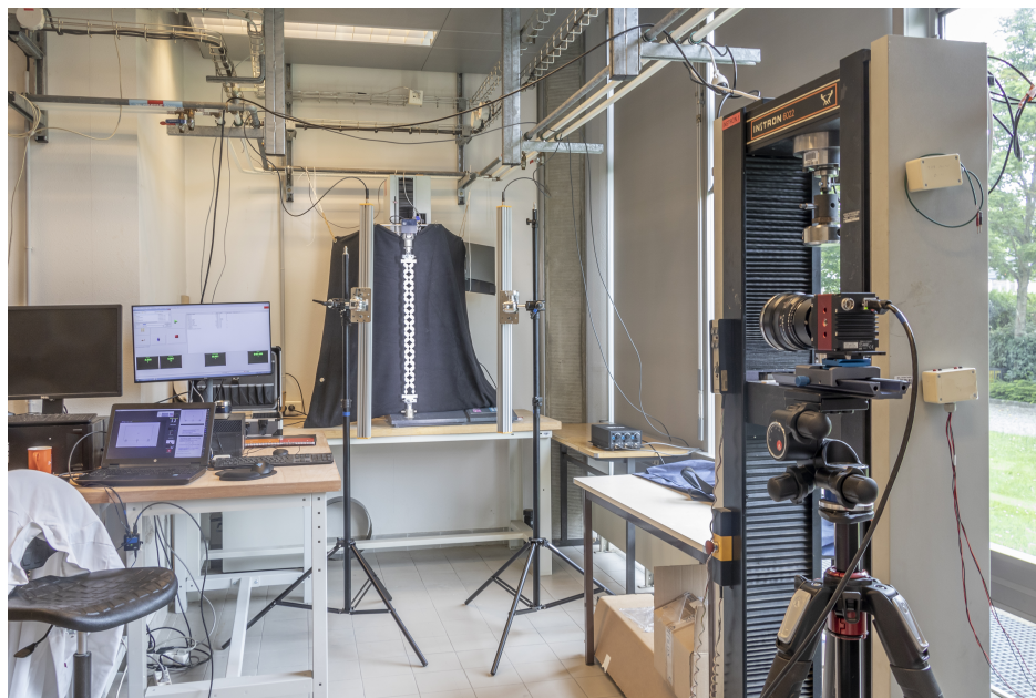
FIGURE IV.14 – Photographie du dispositif expérimental utilisé pour l'étude du comportement mécanique d'échantillons de bandes architecturées.
