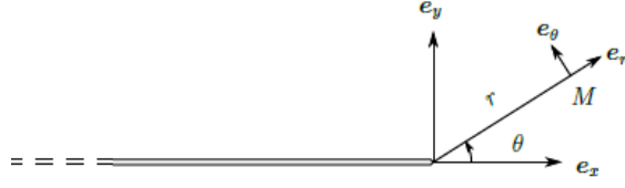
FIGURE A-1 – Repère local au niveau de la pointe de fissure
