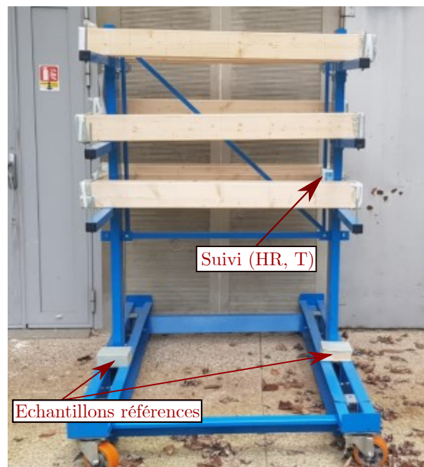
FIGURE 5.6 – Poutres à l'extérieur
