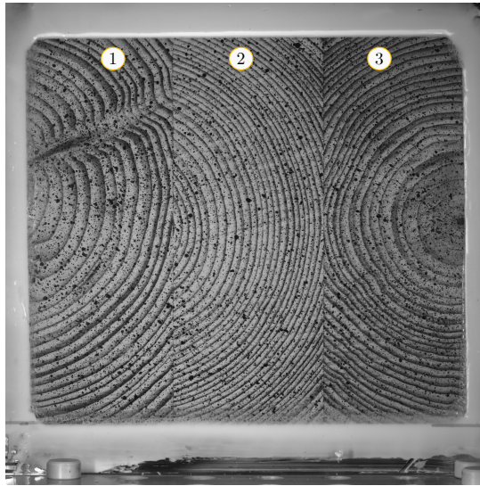
FIGURE 8.3 – Section de lamellé-collé observée au cours de l'essai.
