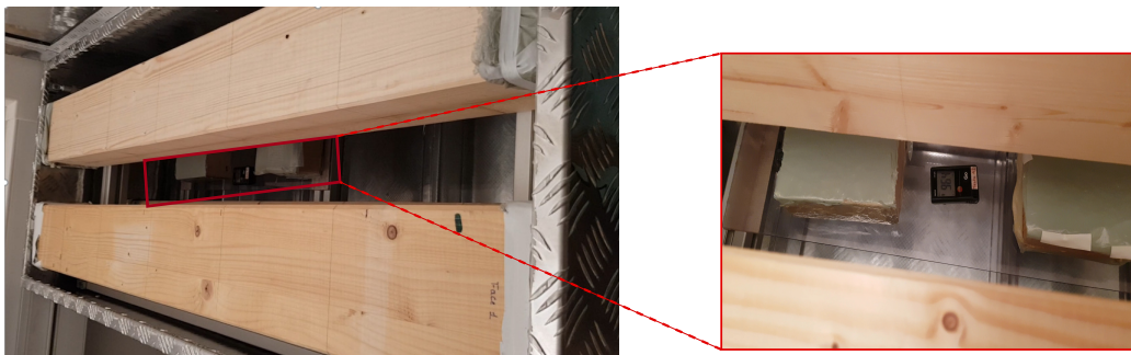
FIGURE 5.4 – Vue du dessus du dispositif de conditionnement des poutres dans la caisse. À gauche : vue globale du dispositif. À droite : un focus sur la partie inférieure de la caisse où se trouvent l'hygromètre et les échantillons de référence.
