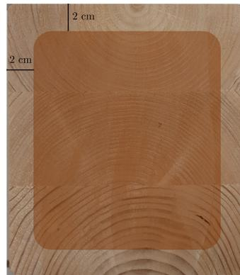
FIGURE 6.18 – Épaisseur affectée par la pénétration de l'humidité dans le cas des essais à l'extérieur.
