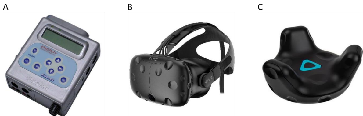
Figure 8 - Illustration du matériel utilisé dans les expérimentations. (A) Stimulateur électrique Micromed. (B) Casque de réalité virtuelle HTC Vive. (C) Capteur de suivi des mouvements Vive Tracker.
