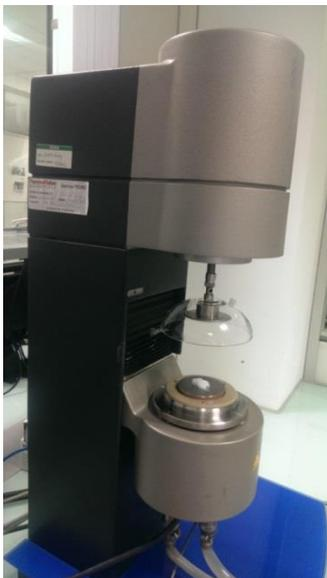
Figure 35. Photo du montage Rhéomètre RS600, de Thermofisher équipé de la géométrie cône-plan et muni de sa cloche en verre.
