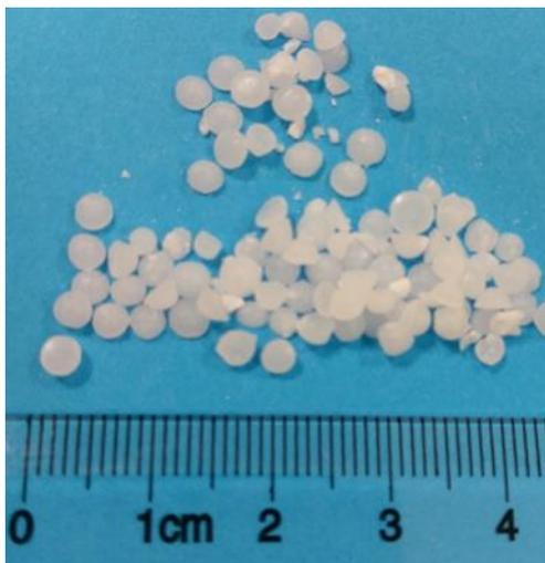
Figure 26. Photo du mélange équimassique d'alcool cétyl stéarique  $C_{16/18}OH$ .
