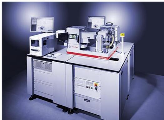
Figure 34. Photo du montage SAXSpace d'AntonPaar.
