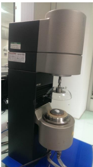
Figure 35. Photo du montage Rhéomètre RS600, de Thermofisher équipé de la géométrie cône-plan et muni de sa cloche en verre.
