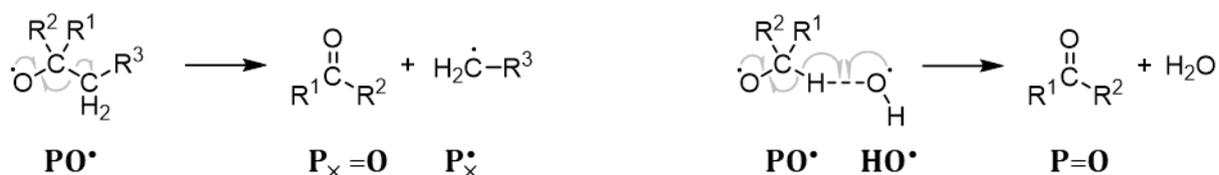
**Schéma 8** – Réactions impliquant des radicaux alkoxy entrant en compétition dans le mécanisme d'oxydation – (**à gauche**) réaction de  $\beta$ -scission – (**à droite**) réaction radicalaire bimoléculaire.
