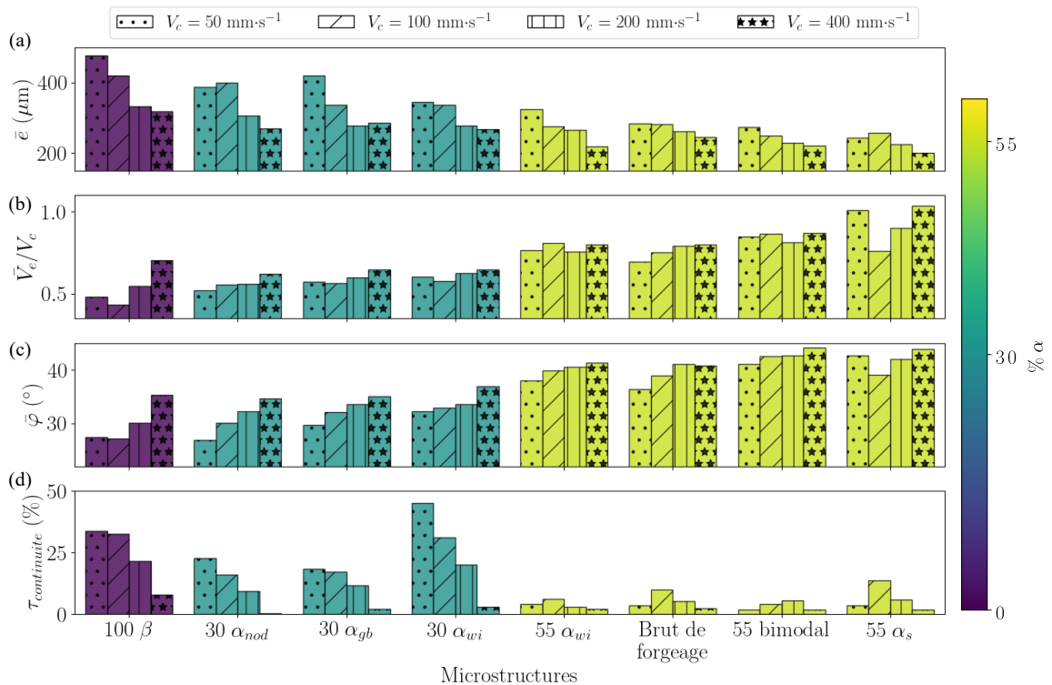
FIGURE IV.26 – Évolution de (a) l'épaisseur de copeau e , (b) du rapport V_e/V_c (c) de l'angle de cisaillement \varphi et (d) du taux de continuité \tau_{continuite} pour chaque vitesse de coupe V_c en fonction de la microstructure.
