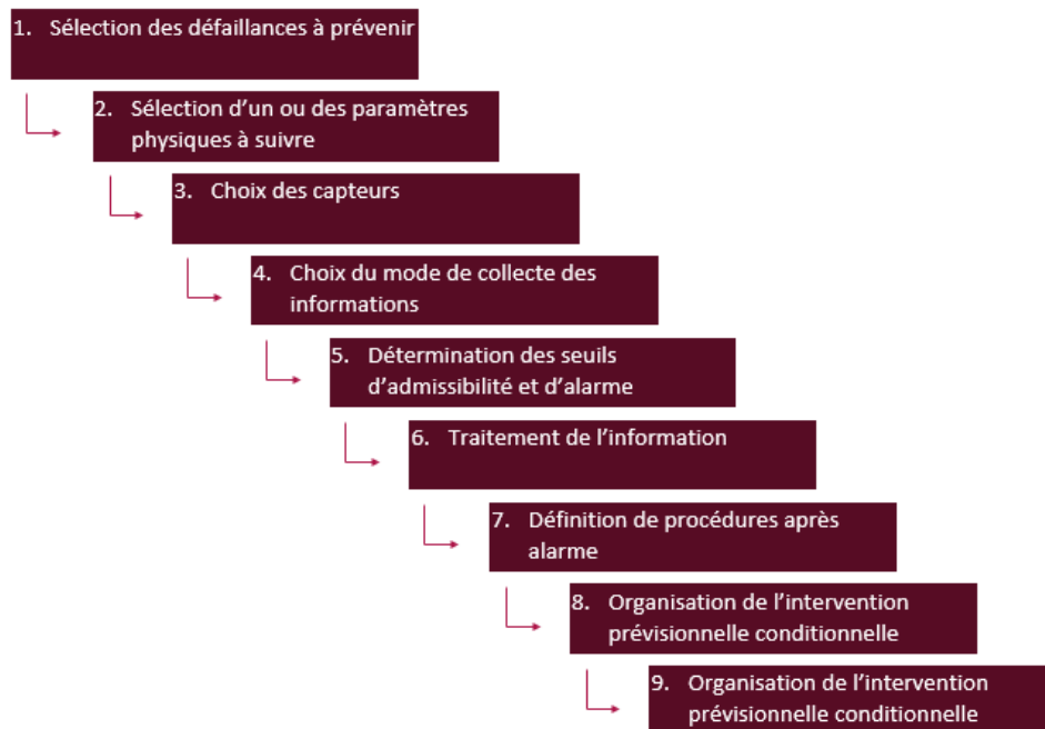
Figure 67: Etapes de mise en œuvre de la maintenance conditionnelle au SIAAP
