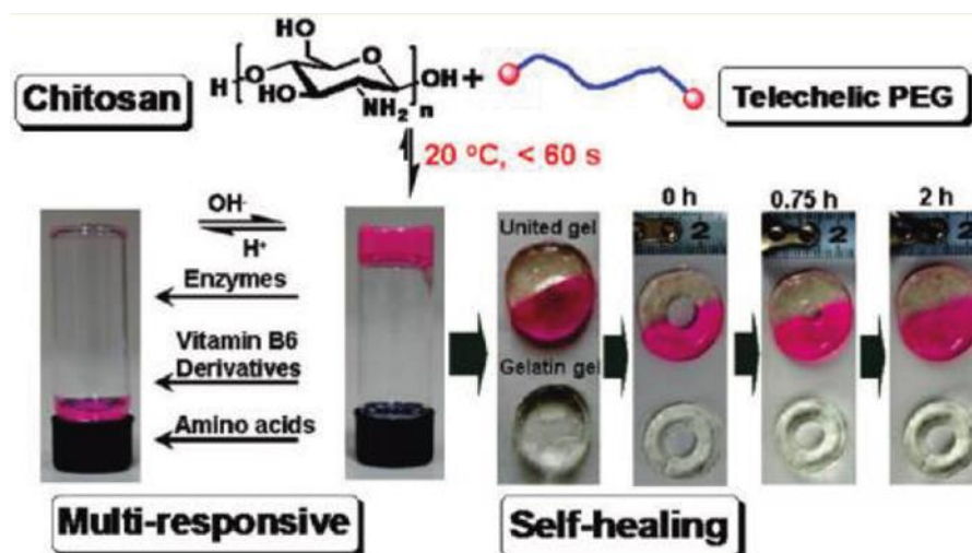
Figure I. 56 Hydrogel à liens imines formé à partir de chitosane et de PEG téléchélique possédant des propriétés d'auto-réparation et multi-stimulable 195
