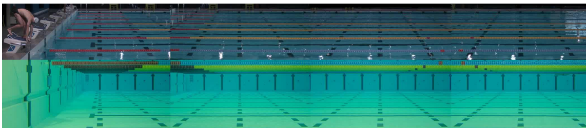
FIGURE 1.18 – Recollement des quatre caméras aériennes et des quatre caméras aquatiques les plus proches du bord du bassin. Les aberrations de perspective et des distorsion ont été corrigées. Chaque caméra couvre 5 mètres.
