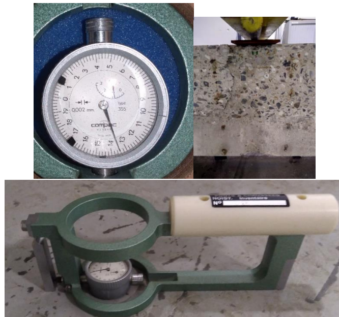
Figure 130 : Déformètre à billes et positionnement des billes
