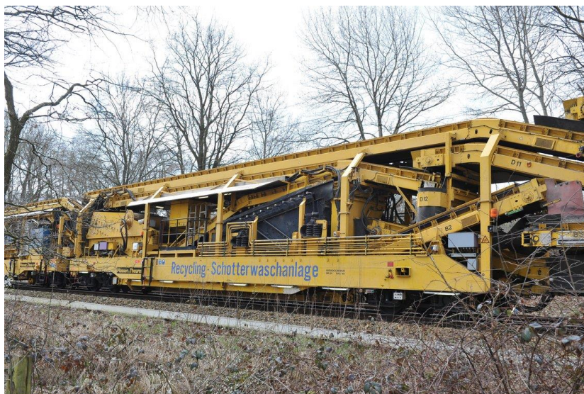
Figure 77 : Dispositif de nettoyage de Ballast intégré au train usine. Il intègre un crible de tri et un crible-laveur à haute pression 39
