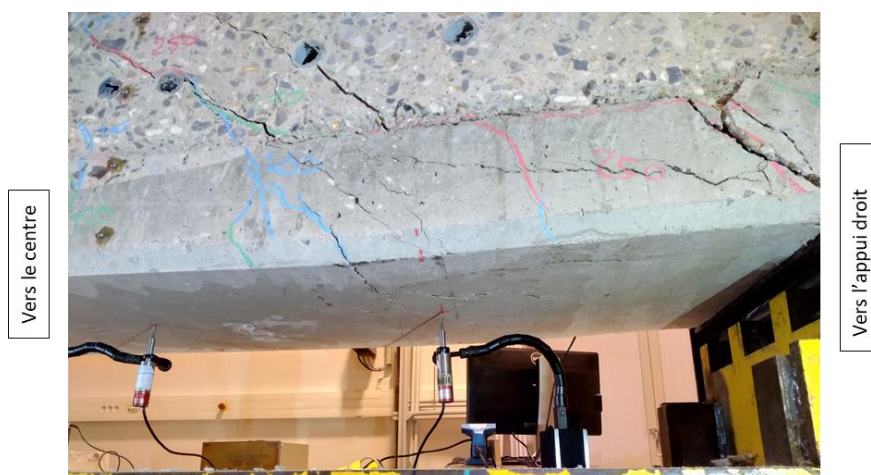
Figure 140 : Extrait représentatif de la fissuration proche de la ruine pour la poutre PuP1 (vert (sous le bleu) : 150 kN, bleu : 200 kN, rouge : 250 kN, vert (sur le bleu) : 270 kN)
