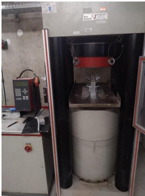
Figure 123 : Dispositif de fendage des carottes de béton
