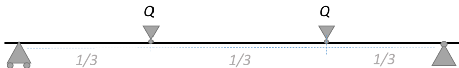
Figure 119 : Schéma flexion 4 points
