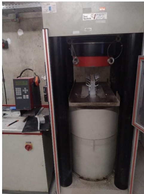
Figure 123 : Dispositif de fendage des carottes de béton
