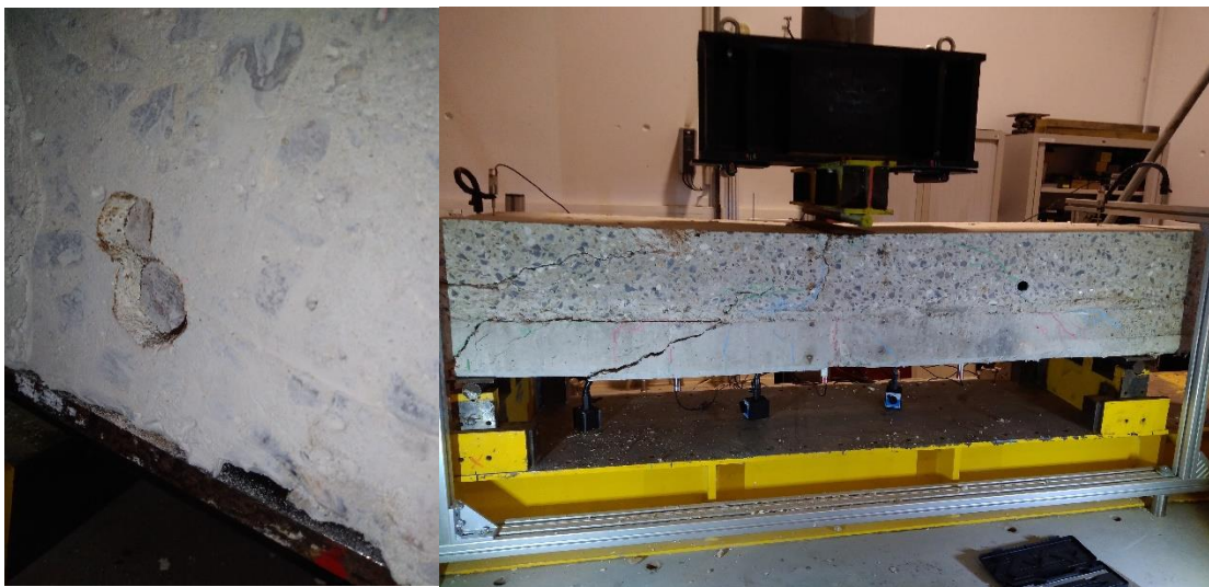
Figure 142 : Poutre PuP2 après rupture (à l'ENPC)
