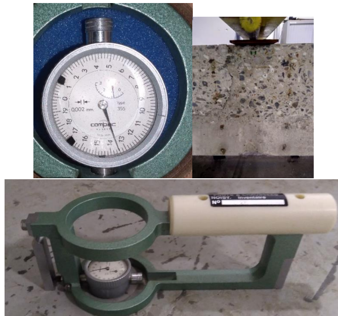
Figure 130 : Déformètre à billes et positionnement des billes
