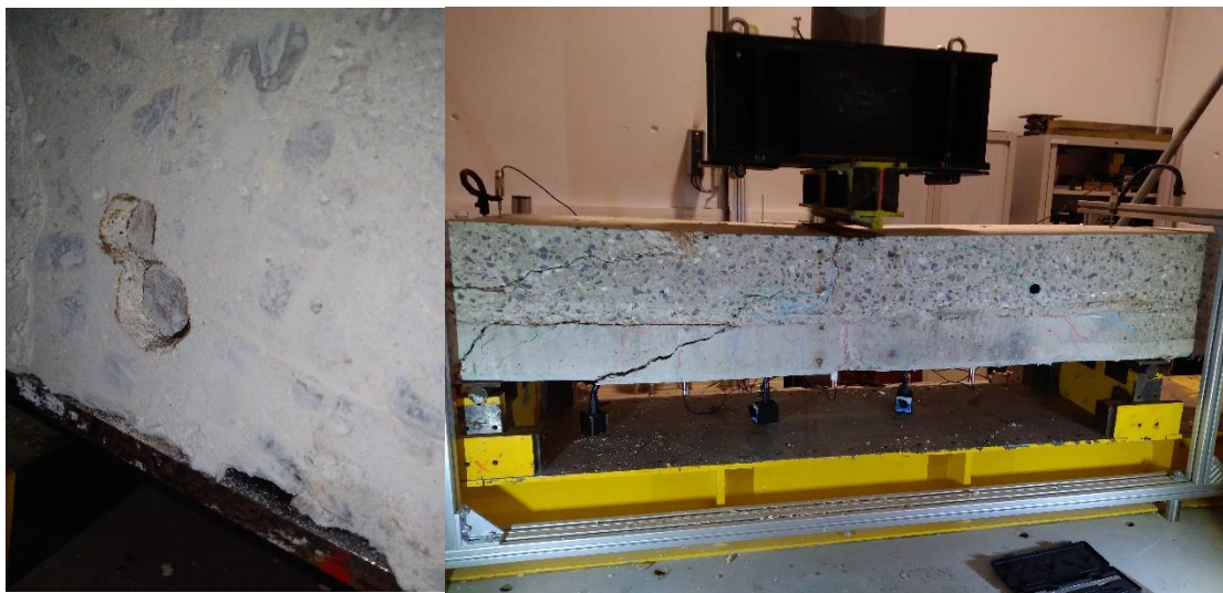
Figure 142 : Poutre PuP2 après rupture (à l'ENPC)
