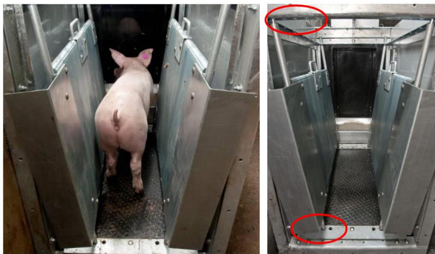
Figure 4.3 Système de bat-flancs réglables permettant d'adapter la largeur du DAC au gabarit des animaux (Source : Nedap N.V., Groenlo, The Netherlands).
