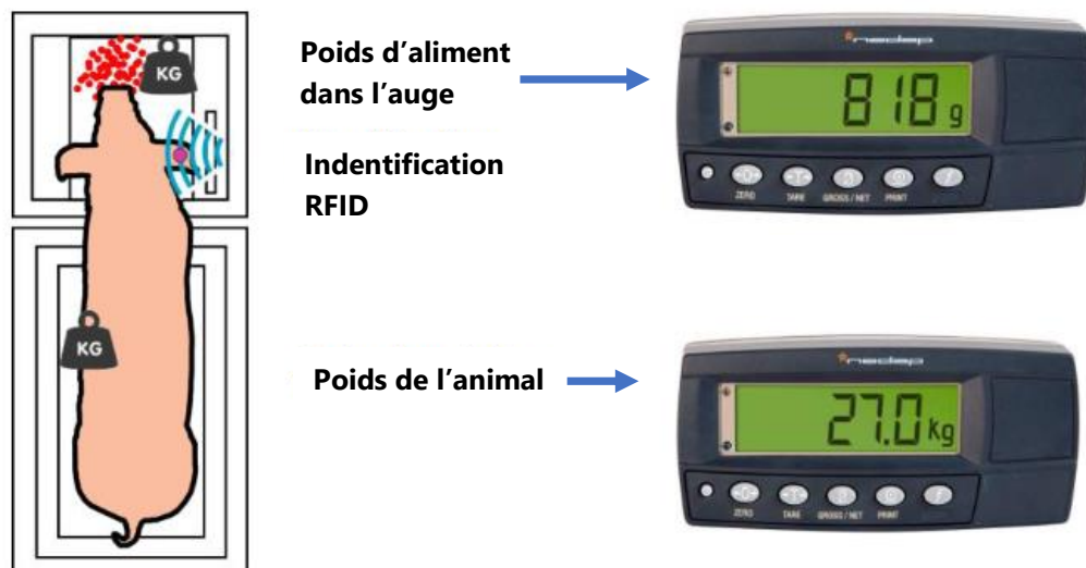
Figure 4.1 Schéma de fonctionnement d'un DAC. Le DAC est équipé de deux pesons : un premier permet de mesurer le poids d'aliment dans l'auge, le second de mesurer le poids de l'animal. L'identification se fait à l'aide de la puce RFID de l'animal. (Source : Nedap N.V., Groenlo, The Netherlands).
