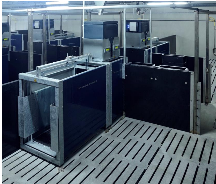
Figure 3.10 Distributeur automatique de concentré (DAC) Nedap PPT (Nedap N.V.; Groenlo, the Netherlands)
