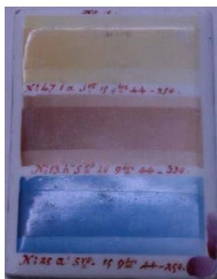
Figure 16 Echantillon de Bleu Outremer N°25 produit en 1844
