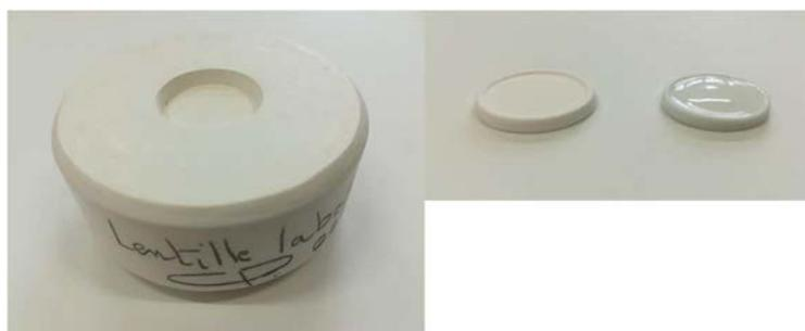
Figure 46 Moule en plâtre servant à la préparation des pastilles de porcelaine, pastille de porcelaine dégourdie (gauche) et pastille émaillée (droite).
