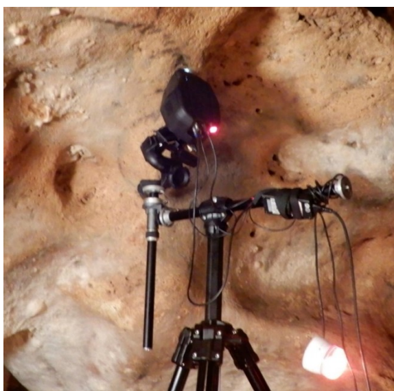
Figure 12 : Spectromètre XRF utilisé lors de la thèse : Elio de XG Lab/Brucker. Ici en analyse dans la grotte, © C2RMF Anne Maigret
