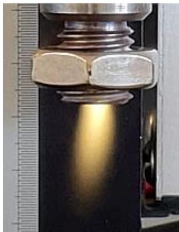
Figure 2-7 : Exemple de photographie prise pour évaluer la longueur de la post-décharge (partie visible)
