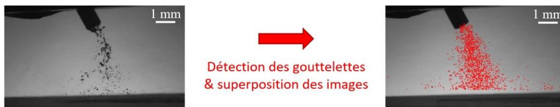
Figure 2-18 : Exemple d'image obtenue par ombroscopie et traitement des données
