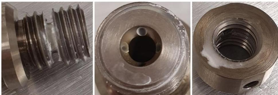
Figure 2-5 : Photographies illustrant le colmatage de la buse d'injection
