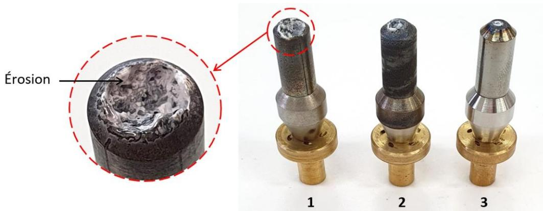
Figure 3-18 : Photographies des trois électrodes utilisées et mise en évidence du phénomène d'érosion
