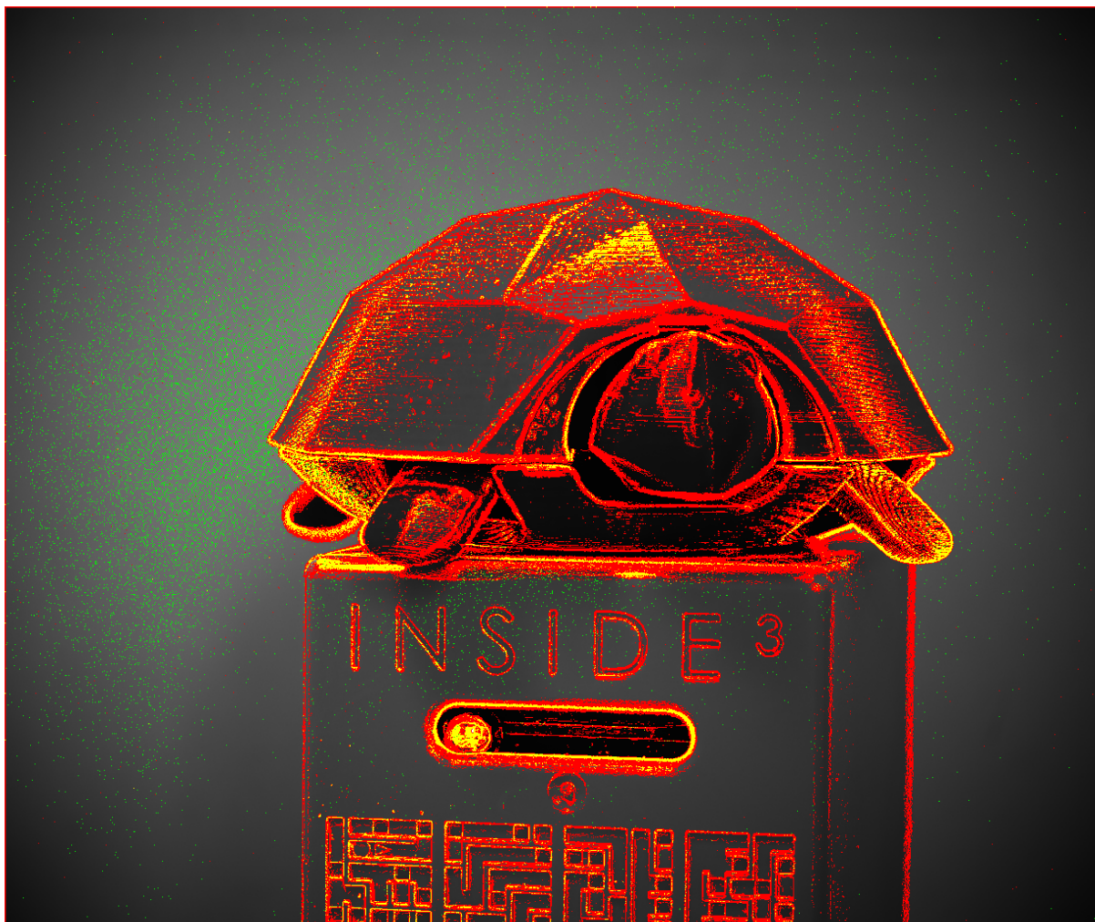
FIGURE 4.9 – La scène est ici composée d’une tortue en plastique imprimée en 3D. Le critère de redondance apparaît en vert et la détection des variations d’intensité apparaît en rouge. On fait apparaître en jaune les super-pixels pour lesquels les deux critères détectent un problème.
