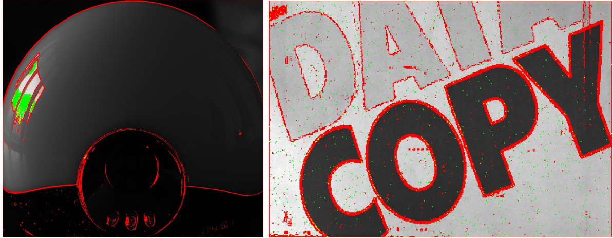
FIGURE 4.7 – Les images polarimétriques utilisées sont les mêmes que sur la Figure 4.4. Les deux critères sont utilisés pour créer la carte d'erreur. Le critère de redondance apparaît en vert et la détection des variations d'intensité apparaissent en rouge. On fait apparaître en jaune les super-pixels pour lesquels les deux critères détectent un problème.
