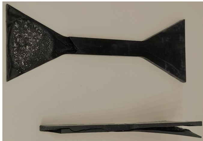
Figure 56 : Photographie d'éprouvettes endommagées durant un vieillissement thermo-hydro-glycolé sévère.
