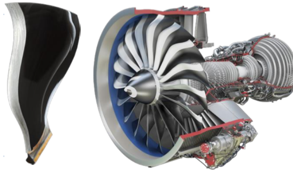
FIGURE 1.17 – Exemple d'un assemblage de matériaux composites et de métal : une aube de turbine de Safran 3
