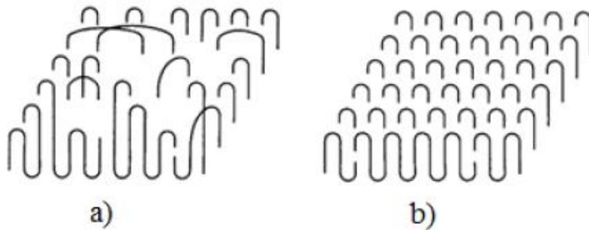
**Figure I. 5:** Modèles de repliement de chaîne : aléatoire (a), régulier (b) (25)
